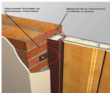
Самый устойчивый к взлому способ установки. Минимальная толщина стен без штукатурки при данном способе установки 210 мм. Крепление на монтажных пластинах. Дверной блок полностью углублен в проем.
