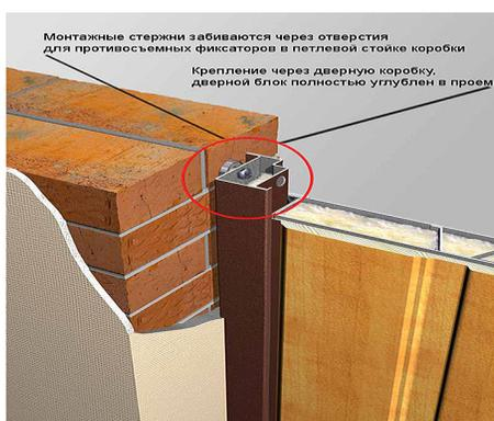
Рекомендуется для проемов с толщиной стен без штукатурки от 160 мм. Крепление через дверную коробку. Дверной блок полностью углублен в проем. Монтажные стержни забиваются через отверстия для противосъемных фиксаторов в петлевой стойке дверной коробки.
