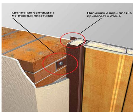
Рекомендуется для проемов с толщиной стен без штукатурки от 160 мм. Крепление на монтажных пластинах.
