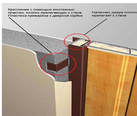
Рекомендуется для проемов с толщиной стен без штукатурки от 120 до 160 мм.
