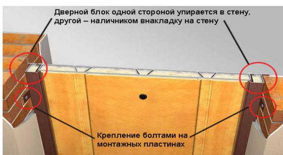
Оптимальный технологический зазор по периметру при данном способе установки 5 мм на сторону для наиболее качественного оштукатуривания проема. Допускается колебание данного зазора от 0 до 15 мм.
